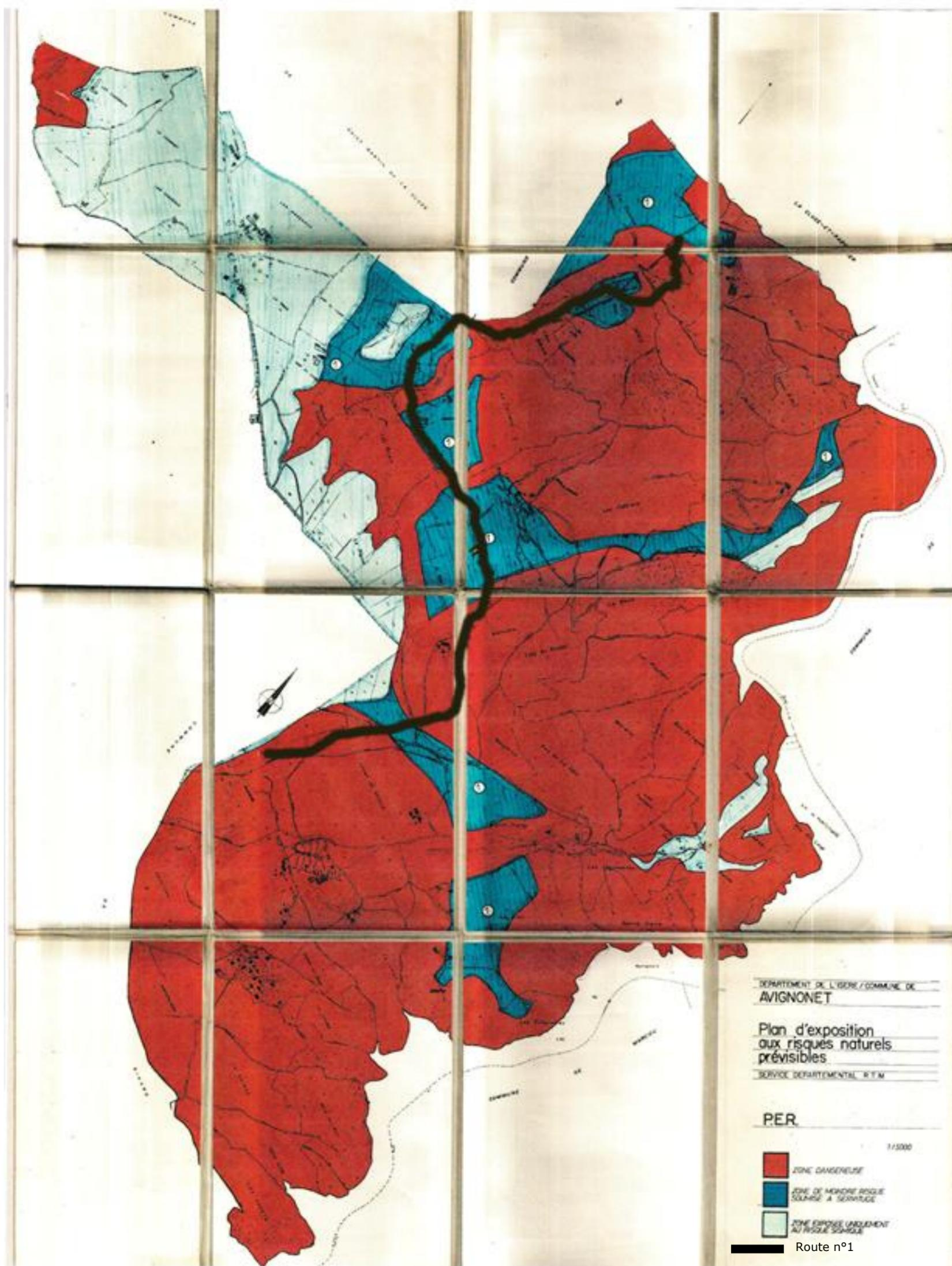
Figure 2 : PPRN d'Avignonet – Zonage réglementaire des risques
